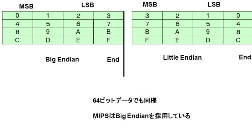
I/Oデータなどを扱う上での無駄を防ぐために、最近のCPUは32ビットではなく8ビット単位で番地が振られています。すなわち、32ビットは番地4つ分に当たります。ここで、桁の大きい方から0, 1と振っていく方法と小さい方から0, 1と振っていく方法の二つが考えられます。前者をBig Endian, 後者をLittle Endianと呼びます。ここでは以降、Big Endianで番号を振ることにします。この振り方は統一が取れておらず、コンピュータ間でデータを交換する際にトラブルの元となります。最近のCPUは電源投入時の指定でどちらの方法を取ることもできるものが多いです。MSB側から0を振っていくと、大きい方で端(LSB: end)に達することからBig Endian, LSB側から0を振っていくと小さい方で端に達することからLittle Endianという名前になっていることが分かります。Endianとは奇妙な英語ですが、これはこの言葉が、ガリバー旅行記の卵の細い方から割る派(Little Endian)と太い方から割る派(Big Endian)で内乱が起きる話に由来するためです。
