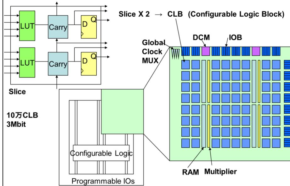
この図はXilinx社のVirtexシリーズの基本構成です。論理要素の配列の間にRAM, 乗算器などのIPが配置されており、DCM(クロックのコントローラ)、クロックバッファが周辺に配置されています。
