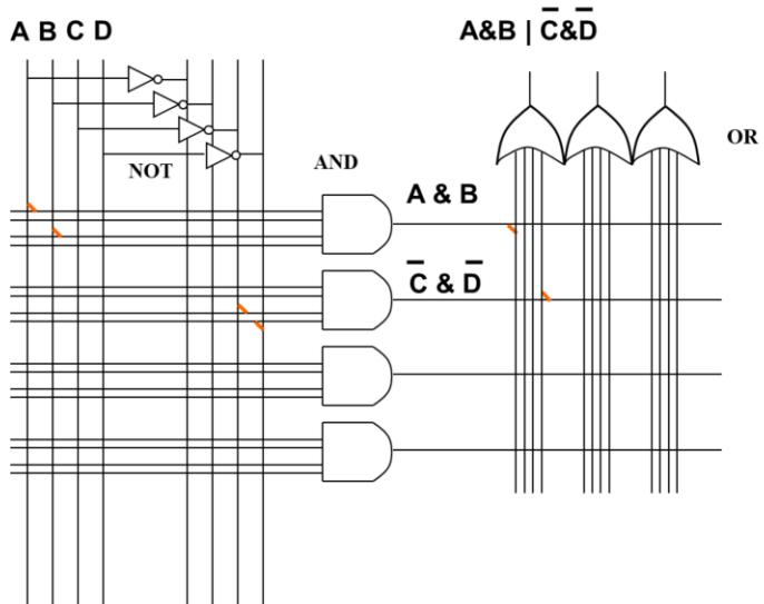
この例ではA&BとCバー&Dバーの論理積を実現する結線を示します。このように一つ一つの積項をANDゲートで作り、これらをORゲートに入力します。
