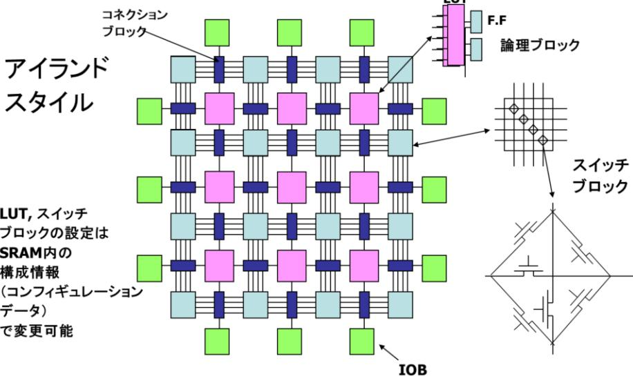
FPGAは今までのAND-OR構成と違って4-6入力程度のLUT2セット程度を一つの論理要素として使います。それぞれの出力にはD-FFを備えます。この論理要素の周辺に配線を敷き詰め、交点にスイッチブロックを置きます。スイッチブロックはトランジスタのON/OFFで接続をON/OFFし、論理要素間の配線を自由に行えるようにします。また、論理要素と、配線の間にも同様のコネクションブロックを置き、論理要素との入出力配線を制御します。また、チップの入出力PINとの間の配線も行います。LUTの内容、スイッチブロックのトランジスタのON/OFFを設定することにより、様々な回路構成を実現することができます。この設定情報を構成情報(Configuratiion Data)と呼び、これをどのように蓄えるかによりFPGAの性質が決まります。このような構成を、配線の海の中に論理要素の島があるイメージからアイランドスタイルと呼ぶ場合があります。
