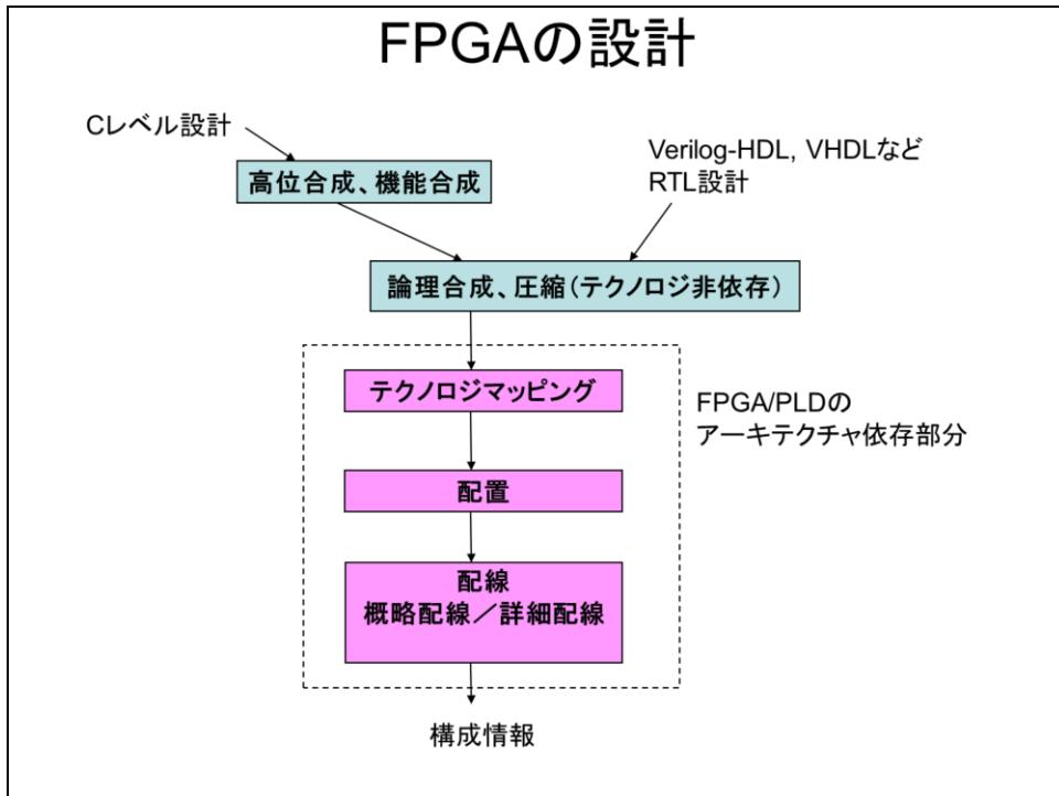
設計は、Verilog-HDLやVHDLなどのハードウェア記述言語で行うことが多いのですが、最近はCレベルでの設計も多く使われるようになりました。これらの記述は論理合成、圧縮の手順を経て、対象のFPGAの種類に応じてゲートなどの割り当て(テクノロジマッピング)が行われ、配置、配線の結果、構成情報が出力されます。これをFPGAに流し込めば、設計通りの動作を行わせることができます。
