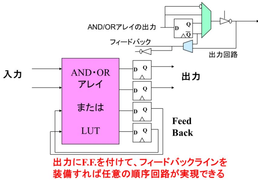
組み合わせ回路の出力にD-F.F.を付け、さらにフィードバックを付けることで順序回路が実現できます。このためには、F.F.の出力回路を選択可能にしてやる必要があります。図はLattice社のGALの出力回路の例です。出力はF.F.を介したものと介さないものが選択可能で、3ステート出力になっています。また、組み合わせ回路にフィードバックすることもできるようになっています。このような構成のPLDをSimple PLD(SPLD)と呼びます。
