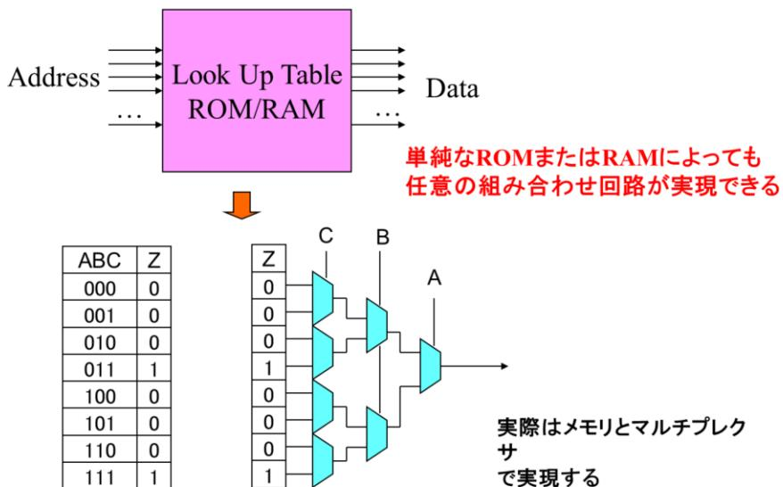
単純なメモリは、アドレスを入力、データを出力として考えると、真理値表の代わりに使えるので、任意の組み合わせ回路を実現することができます。しかし、通常のメモリは小さい面積で大きな容量を実現するのに特化した構造を持っているので、小規模の入出力で高速性が要求される論理回路に使う場合不利が大きいです。このため、実際には記憶要素にマルチプレクサのツリーを組み合わせて表を実現します。これをLook Up Table (LUT)と呼びます。
