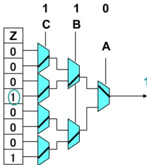
LUTによる論理の実現の例を示します。同じ列のマルチプレクサには同じ制御入力を繋ぎ、1ならば下から、0ならば上からの入力を出力に流します。ABCの順に011を入れると、上から3番目のデータが取り出せることができます。(表と右の図でABCが逆順な点にご注意ください。) すなわちこの回路は表として働いています。マルチプレクサは以前紹介した方法で簡単に作れるので、この方法は入力が6,7よりも小さい場合には効率的です。
