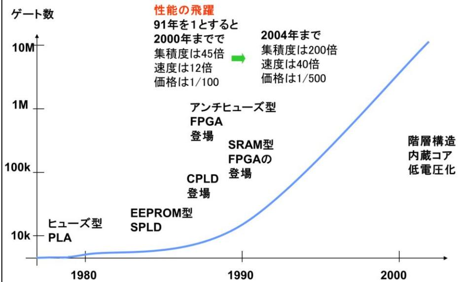
PLDの歴史は案外古く、70年代に用いられたバイナリジャンクショントランジスタを用いたヒューズ型のSPLDに遡ります。この型のSPLDは、単純なAND-OR構造の結線を外部からヒューズを切断することによってプログラムしました。小規模で再プログラムができなかつたが、高速で、当時のデジタルICの主流であったTTL (Transistor Transistor Logic) の74シリーズで実現が困難な特殊な論理回路に用いられました。80年代になってCMOSを用いた再プログラム可能な素子が登場しました。Lattice社のGALシリーズがこの代表で、AND-OR構造にフリップフロップを含んだ出力ブロックを接続することにより、やや複雑な組み合わせ回路、順序回路が実現可能でした。このシリーズは再プログラミング可能であり、簡単なハードウェア記述言語からプログラミングを行う環境も整い、広く利用されるようになりました。
