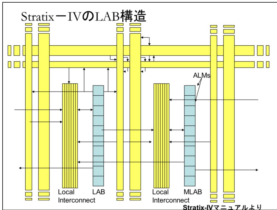
Intel(Altera)のFPGAの特徴は、階層型の強力なネットワークを持つ点です。これにより、Intel社のStratixは非常に複雑な論理回路を搭載しても250MHzを越える周波数で動作します。
