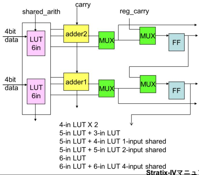
XilinxのライバルのAltera社の基本論理構造です。Altera社は最近Intelに買収され、やや高性能製品に特化している傾向が見られます。Altera社のハイエンド製品Stratixの基本構成要素は、Xilinx同様6入力のLUTを使いますが、このLUTはさらに柔軟に様々な組み合わせを取ることができます。直結線、出力のマルチプレクサ構成など、両社の基本構成要素は似てきてています。
